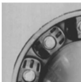
6. Затяните каждый болт максимум на 4 оборота. Повторите процесс по часовой стрелке 2-3 раза, до тех пор, пока эластомер равномерно не выступит между всеми пластинами, работающими на сжатие.
