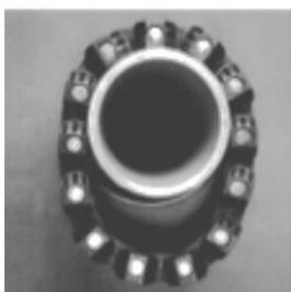
3. Все головки болтов должны быть со стороны монтажника. Возможное провисание цепи нормально. Не удаляйте никаких звеньев. При использовании ЗУКП для труб малых диаметров, понадобится растянуть цепь при монтаже.
