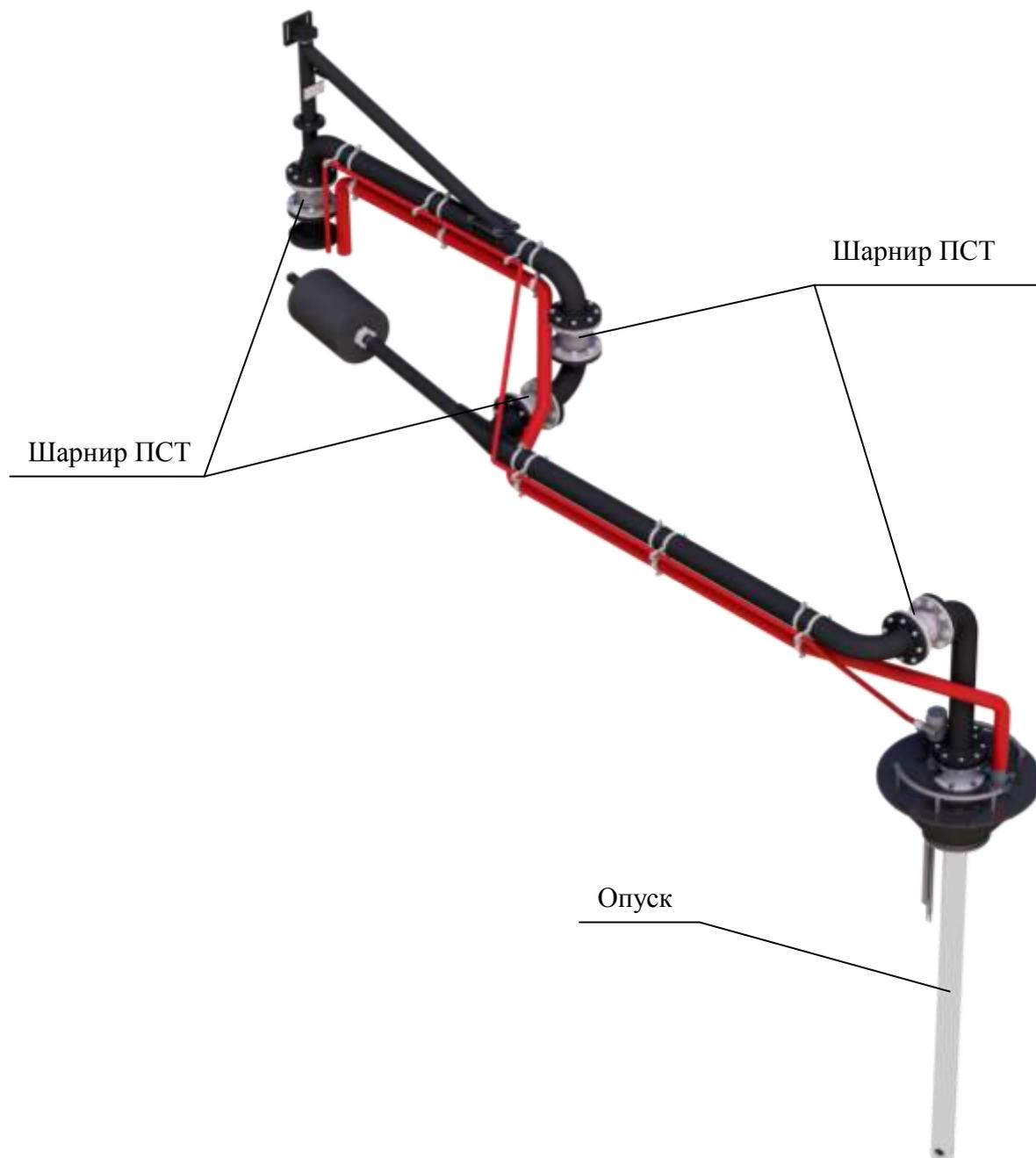
Шарниры ПСТ на стояке могут быть футероваными или изготовлены из титанового сплава, а также из специальных кислотостойких сталей (06ХН28МДТ и т.д.). В стояк шарниры устанавливаются на фланцах, что позволяет быстро менять уплотнения в шарнирах. Опуск стояка имеет внутреннюю и наружную футеровку. Футерованный стояк позволяет использовать для операций слива/налива особоагрессивных жидкостей трубы из более дешевого материала.
