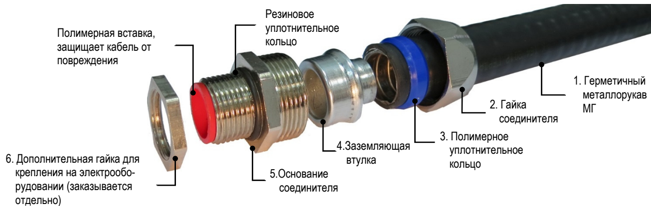
Рисунок 2 Устройство соединителя с наружной резьбой «Н». Соединитель с внутренней резьбой «В» отличается резьбой основания (5).
